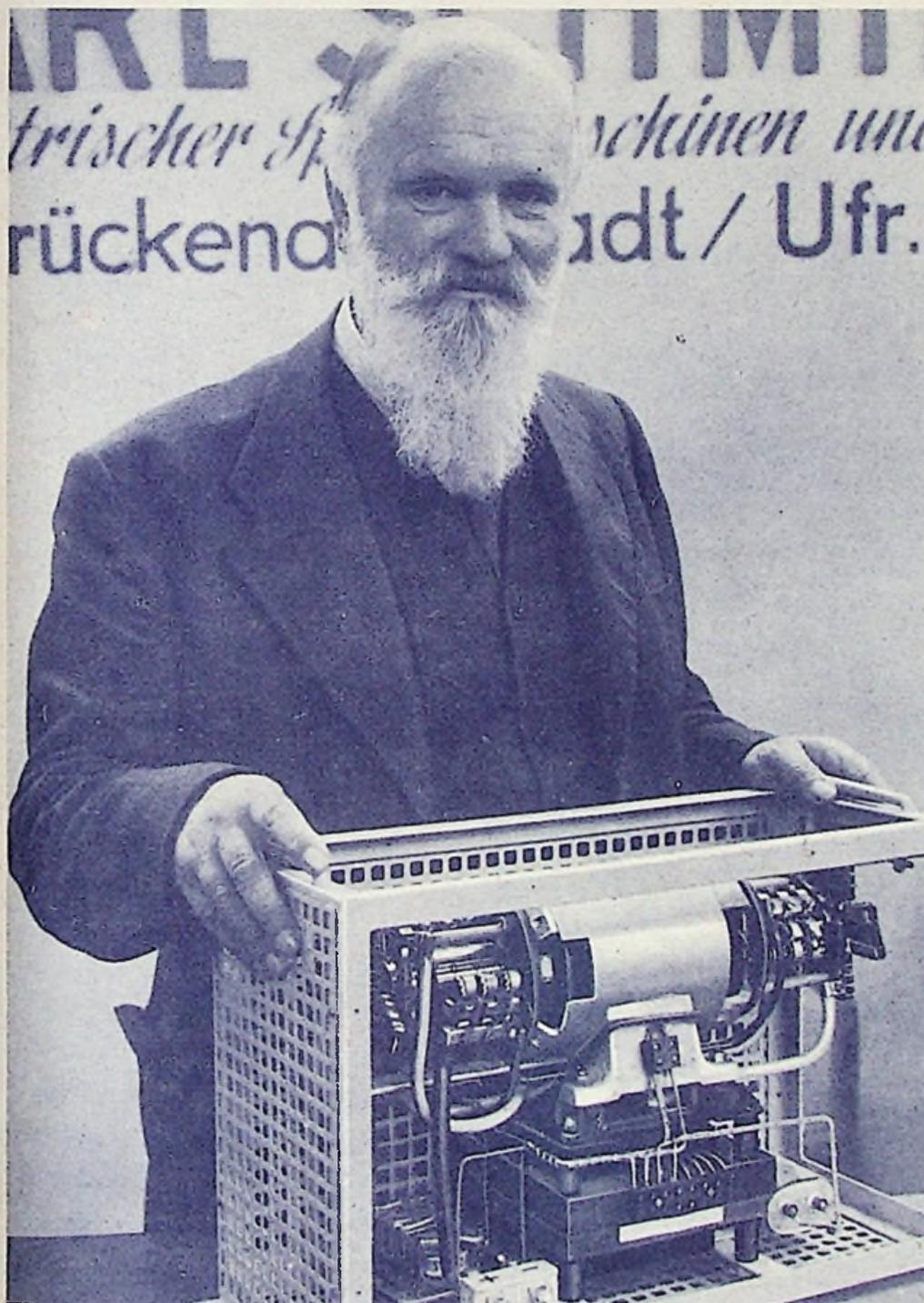
Auf der Münchener Elektromesse zeigte Dr. Ing. Karl Schmidt, der früher bei der C. Lorenz AG. Hochfrequenz-Maschinensender und Spezialmaschinen baute und zu den Pionieren des Maschinensenders gehört, diesen Gleichstrom-Wechselstrom-Umformer. Für die Herstellung der Wechselspannung wird eine rotierende mit Kollektoren und Schleifringen zusammengebaute Widerstandsanordnung benutzt.
