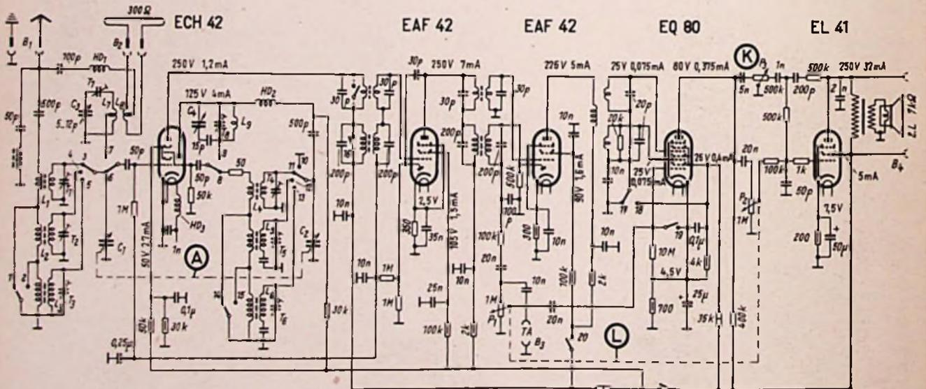
Spannungen mit Röhrenvoltmeter gemessen.
