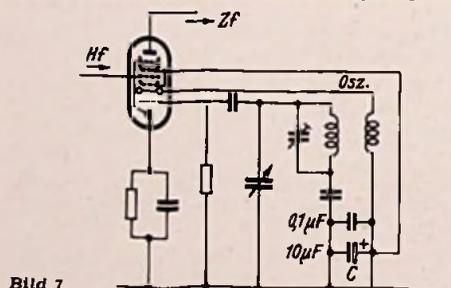
Bild 7. Oktoden-Mischstufe mit Entkopplungsglied (RC) zur Unterdrückung der Blubberneigung
