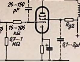
Bild 5. Kapazitive Gegenkopplung in der Endstufe
