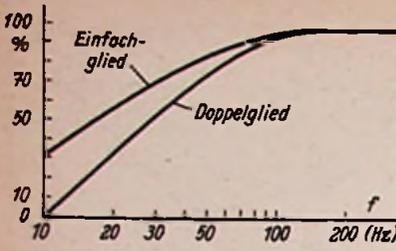
Bild 3. Zweistufiges RC-Kopplungsglied vom Gitter einer NF-Röhre gibt einen steileren Abfall nach tiefen Frequenzen (s. Kurven)
