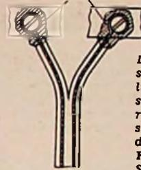
Die Isolation ist so aufgeschnitten, daß sie möglichst weit an die Anschlußklemmen herantreibt. Die blanken Anschlußenden sind nach der Verschraubung mit Hf-Kitt in mehreren Schichten zu überziehen
