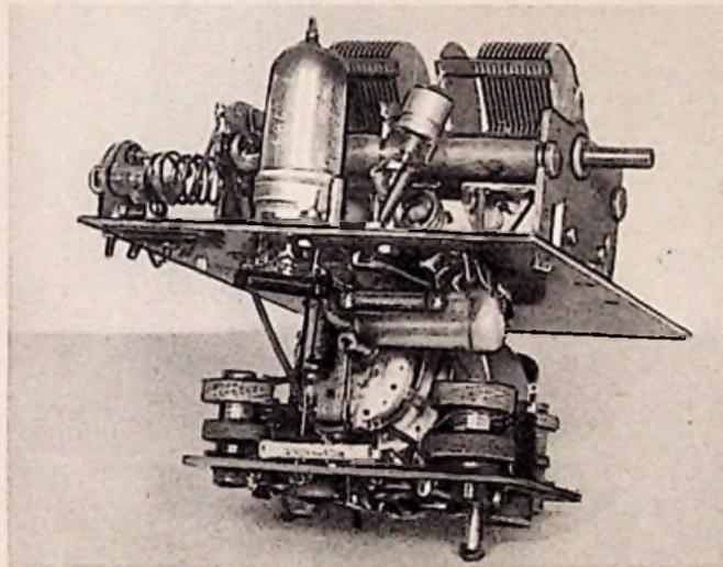
Links oben: Links ist die Mischröhre ECH 42 mit Zweifachdrehkondensator und den UKW-Spulen zu erkennen; hieran schließt sich der ZF-Teil mit der ersten EAF 42 und den beiden Kombinationsfiltern an
