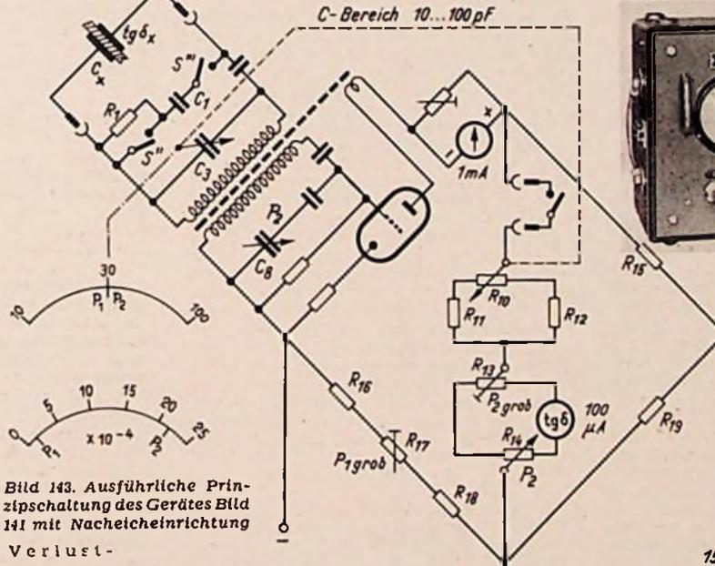
Bild 143. Ausführliche Prinzipschaltung des Gerätes Bild 141 mit Nacheicheneinrichtung
