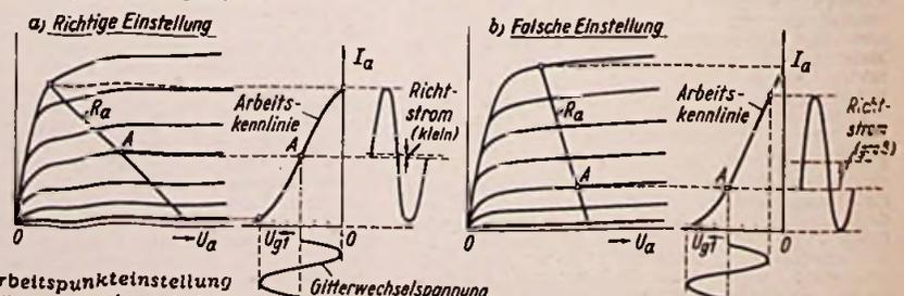
Bild 8. Eine falsche Arbeitspunkteinstellung der Endröhre gibt einen hohen Richtstrom und schafft dadurch günstige Voraussetzungen für das Entstehen des Blubereffekts
