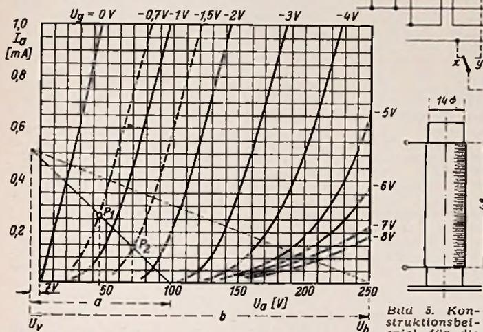
Bild 4.  $I_a-U_a$ -Kennlinienfeld der steileren Triode der EM 4. Die Anode liegt an einem Spannungsteiler, der von  $U_b$  nach  $U_v$  geschaltet ist. Spule  $L_3$ , 45 Windungen Kupferdraht, emalliert, 1 mm  $\varnothing$ ,  $Q = 120$ ;  $L = 6,2 \mu H$ ; Abschirmbecher 30 mm  $\varnothing$ , 60 mm hoch
