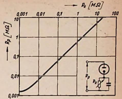
Bild 140. Eingangswiderstand  $R_p$  in Abhängigkeit vom Arbeitswiderstand  $R_k$
