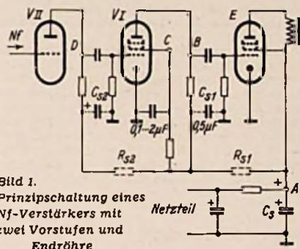
Bild 1. Prinzipschaltung eines Nf-Verstärkers mit zwei Vorstufen und Endröhre
