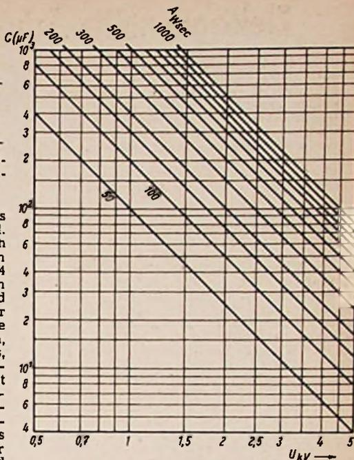
Bild 5. Diese grafische Darstellung umfaßt die drei zusammenhängenden Größen, Kapazität, Spannung und gespeicherte Arbeit und gilt für alle handelsüblichen Blitzzröhren mit Entladeenergien von 50 ... 1000 Wsec
