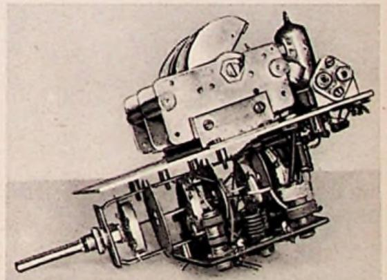
Seitenansicht der Baueinheit „Mischstufe“. Rechts oben ist die Antennenbuchse für den UKW-Dipol sichtbar
